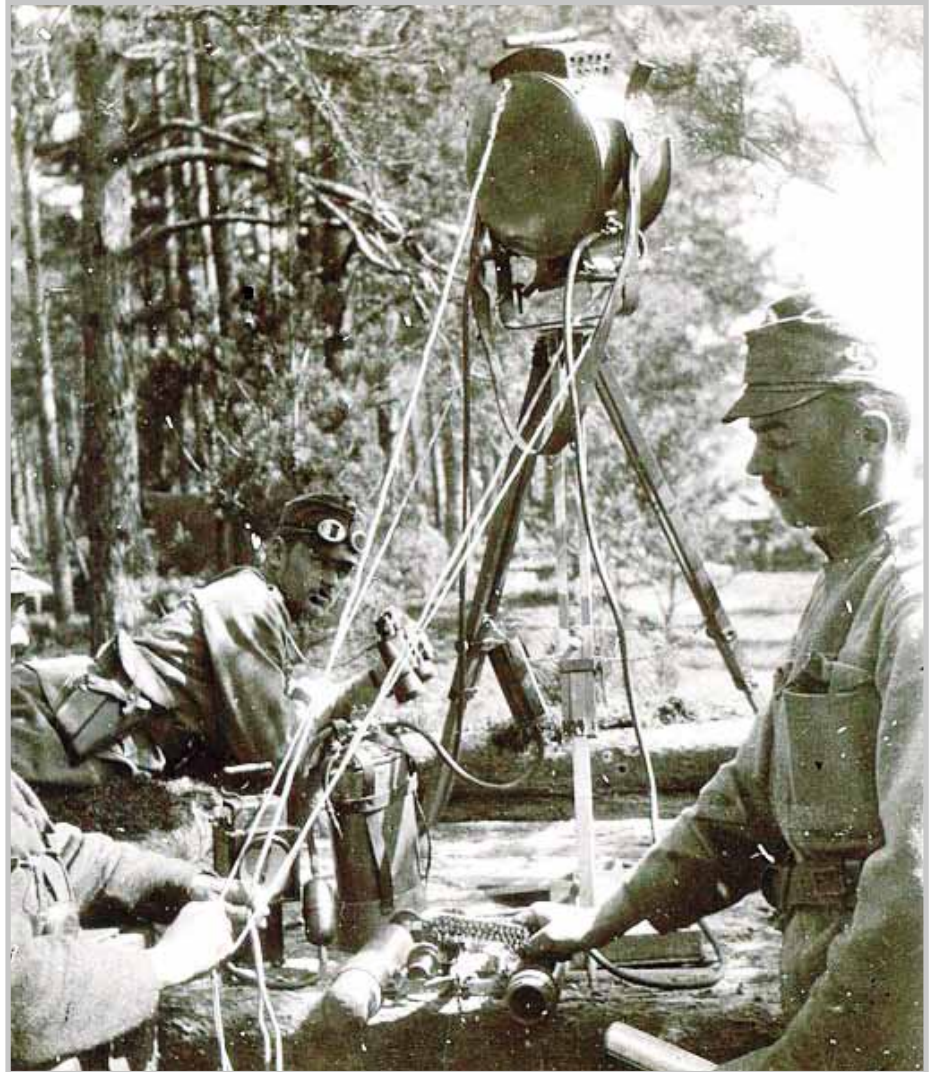
30 cm A.S. (Azetylen-Sauerstoff) Scheinwerfer in Stellung
