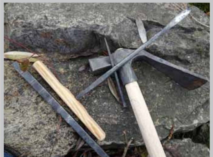
Fotos: Rekonstruierte römische Werkzeuge: eine Axt wird geschmiedet (links), Zollstab, Bohrer, Nagen und Dechsel (rechts).
