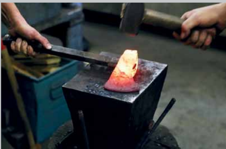
Fotos: Rekonstruierte römische Werkzeuge: eine Axt wird geschmiedet (links), Zollstab, Bohrer, Nagen und Dechsel (rechts).
